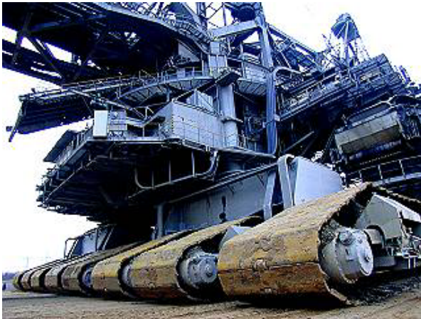
Le train de chenilles principal (16 chenilles de 3m x 14 m de long)
