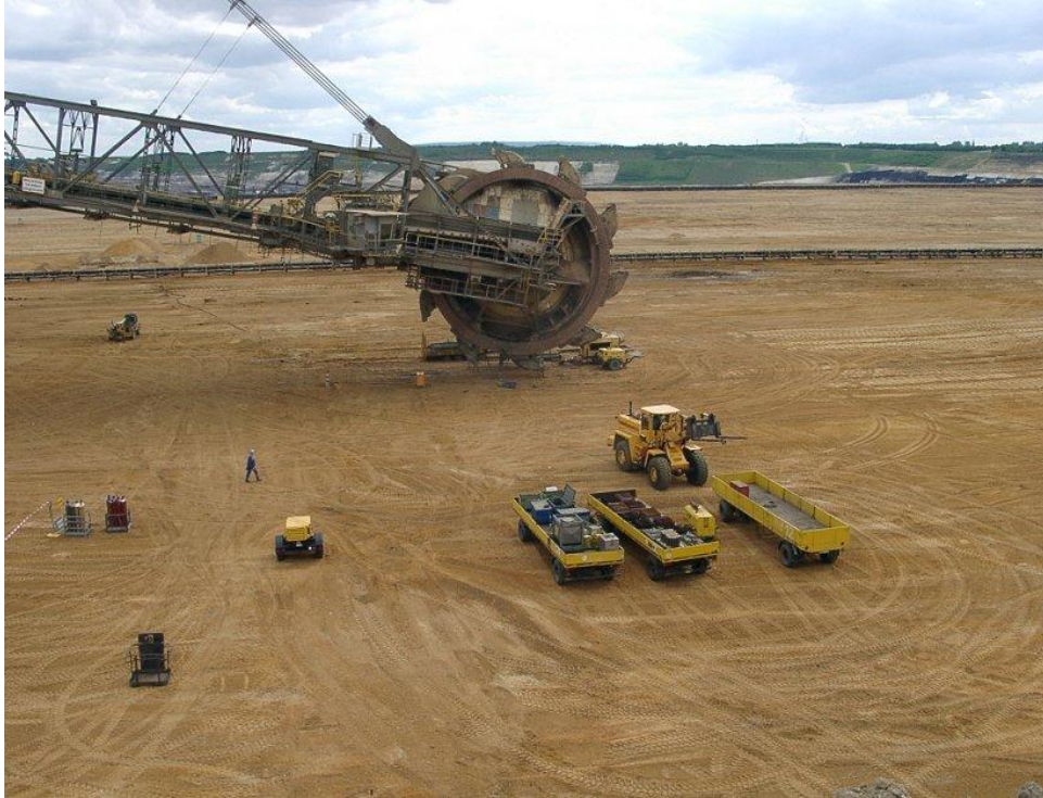
La roue d'une des 'petites' haveuses (bagger 259) avec seulement 10 godets de 2.6 m 3 . Le site entier compte une dizaine de machines, de 7.800 à 13.500 tonnes.
