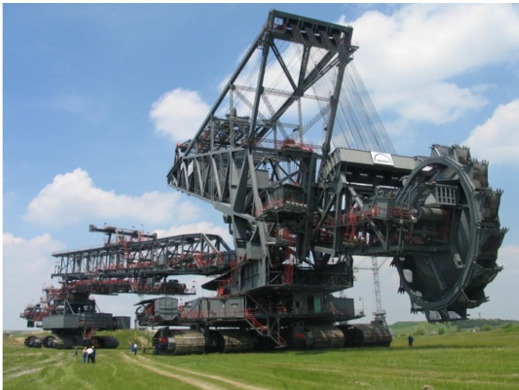
Le plus gros véhicule terrestre jamais construit pèse 14.877 tonnes à vide et mesure 225 mètres de long. Le site web du constructeur est <http://www.takraf.com>
