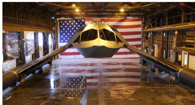
Il déjauge à partir de 8 noeuds et survole l'eau porté par deux "pods" de 20 mètres de long, sortes de torpilles étroites qui ont une friction hydrodynamique réduite d'un facteur 900 par
